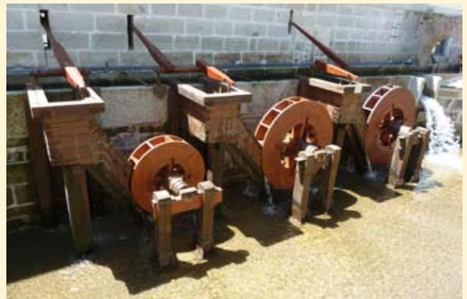
El conjunto de las tres ruedas hidráulicas, la de la izquierda acciona el fuelle, la central el martinete y la de la derecha el torno. Los ejes atraviesan el muro.
