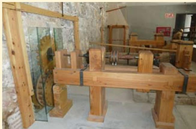
El torno formado por una estructura de madera. El eje de la rueda hidráulica hace girar la linterna inferior y esta mueve la rueda dentada superior.
