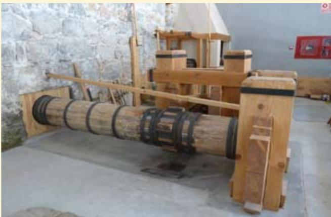
El árbol o eje que acciona el martinete movido por la rueda hidráulica situada en el exterior tras el muro.
